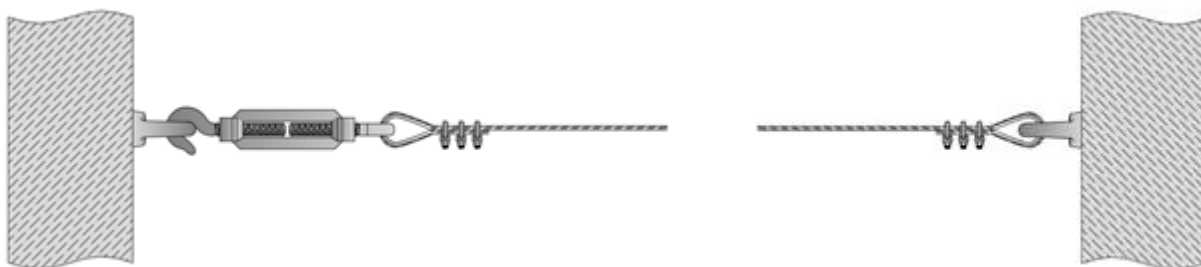
а) Пример крепления концевых конструкций троса к стенам здания:
